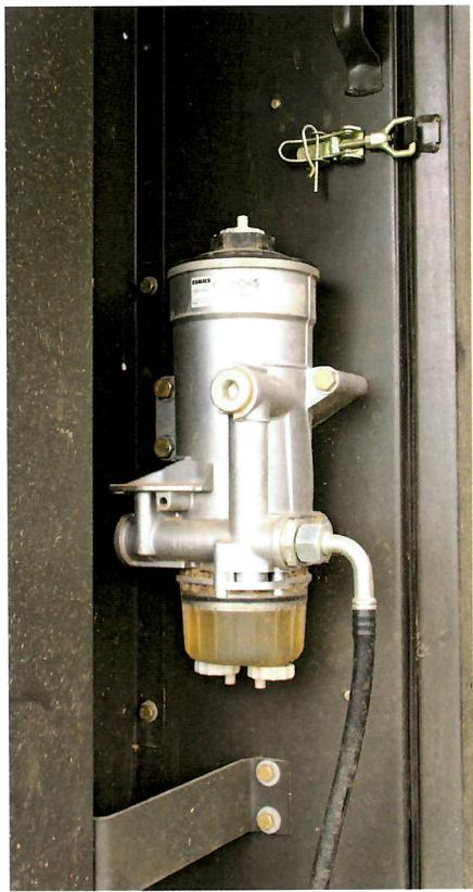
Топливный фильтр вынесен за пределы моторного отсека. Он установлен слева от блока радиаторов
