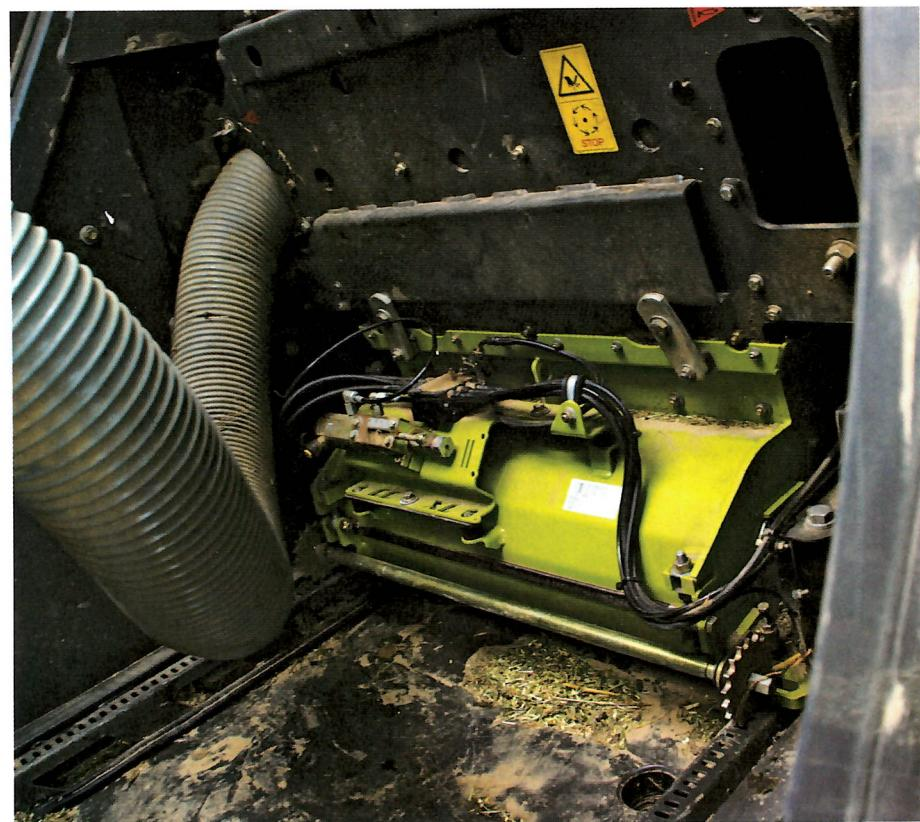
А вот и доизмельчитель зерна *MCC Classic L* с вальцами диаметром 250 мм. При необходимости можно не только устанавливать разнозубые вальцы, но и изменять разность частот их вращения. Для этого нужно прикупить другие шкивы
