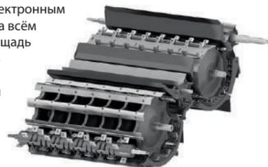
Система обмолота Tetra Processor построена с применением барабана диаметром 800 мм, обеспечивающего стабильный и деликатный обмолот без потерь. Сепаратор диаметром 750 мм способствует движению хлебной массы по плавной траектории. Ширина устройства — 1 650 мм — позволяет достигать производительности комбайна до 40 т/час.
