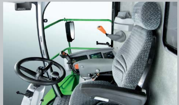
Современная кабина с новой панелью управления и рулевой колонкой, регулируемой в трех плоскостях.
